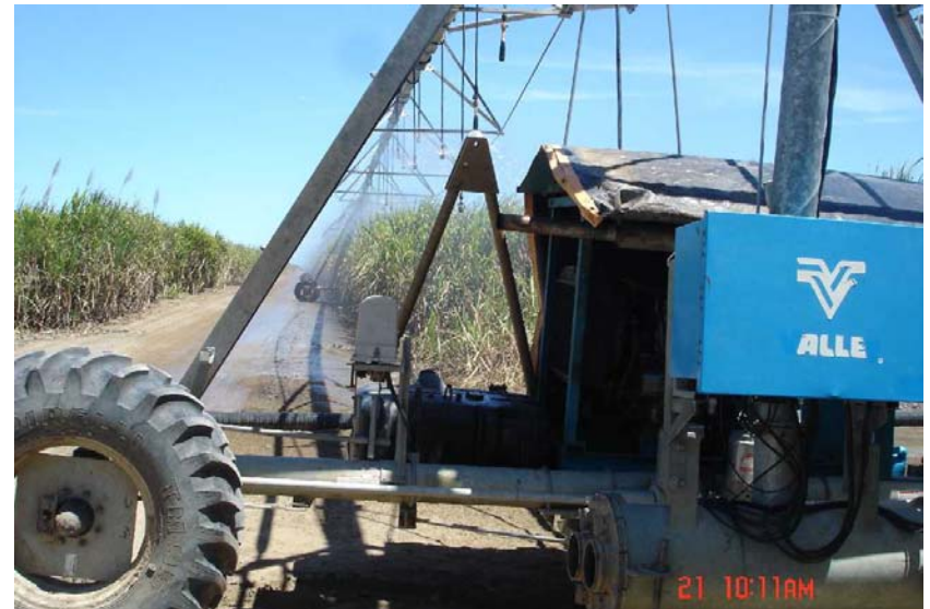
Fotografía 2. Torre principal con conjunto motobomba en equipo del Ingenio caete. Motor diesel de 33cv. Generador de 30 KVA. Longitud 336 metros.
