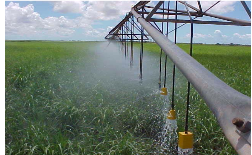
Fotografía 4. Emisores tipo LEPA. Los aspersores mas cercanos a la torre central son distintos para evitar la deriva y que pueda mojarse el generador..
